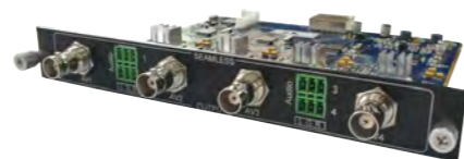
D6104AC 4 Channels AV Digital Output Card
