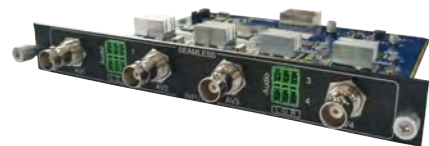
D6104AR 4 Channels AV Digital Input Card
